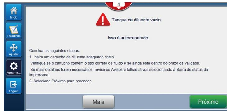
Figura 5: Falha de tanque de diluente vazio (E15062)
