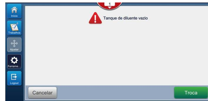
Figura 6: Falha de tanque de diluente vazio (E15062)
